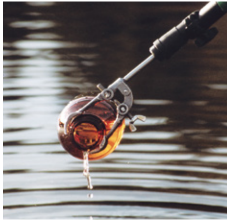
67085 Leukapuristin Mahdollistaa halkaisijaltaan 10-80 mm näytteenottopullojen ja -tölkkien kiinnittämisen teleskooppivarteen vesinäytteiden ottamista varten.
