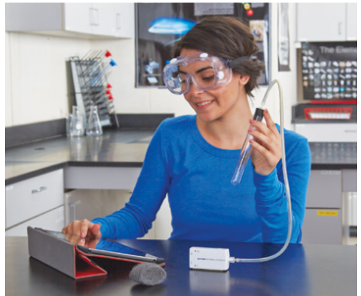
Tarvitset vain koeputken, teräsvillaa ja Langattoman paineanturin mitataksesi hapen määrän ilmassa.
